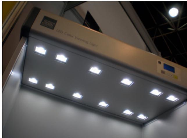
Bild 1. Kalibrierte LED-Lichttechnik in Normlichtkabinen (Foto: Schröder)
